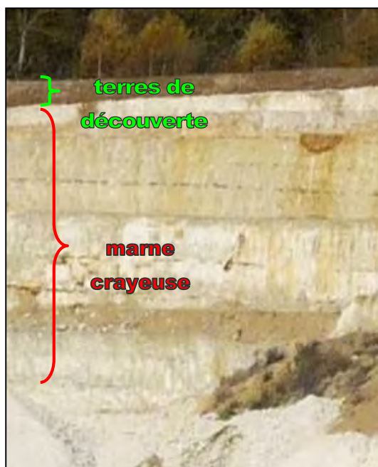
Figure 6 : Prise de vue du gisement en cours d'exploitation sur le site d'étude (AREA Conseil)
